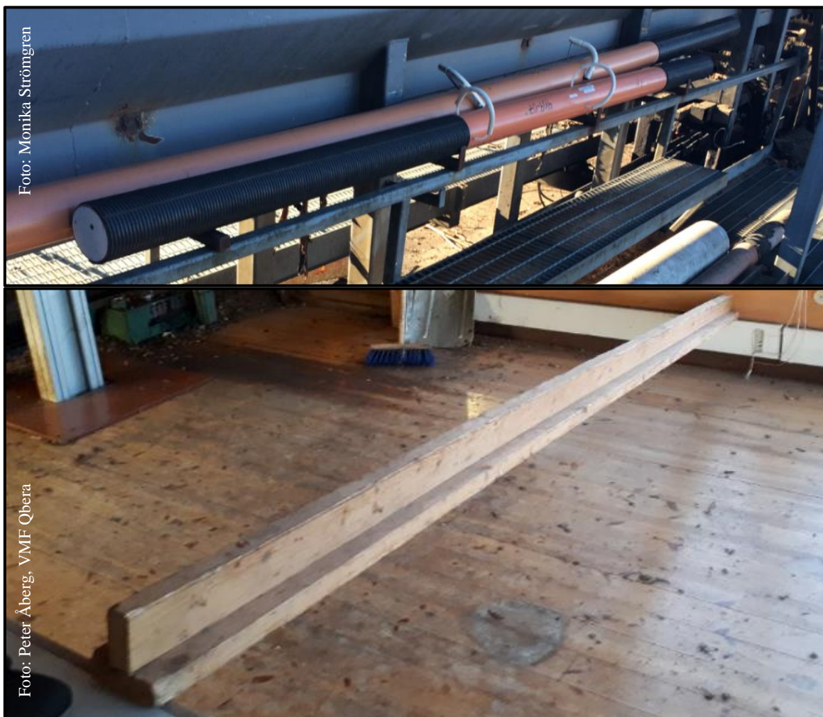
Figur 5. Provkroppar tillverkade av avloppsrör (övre) och trä (nedre).
