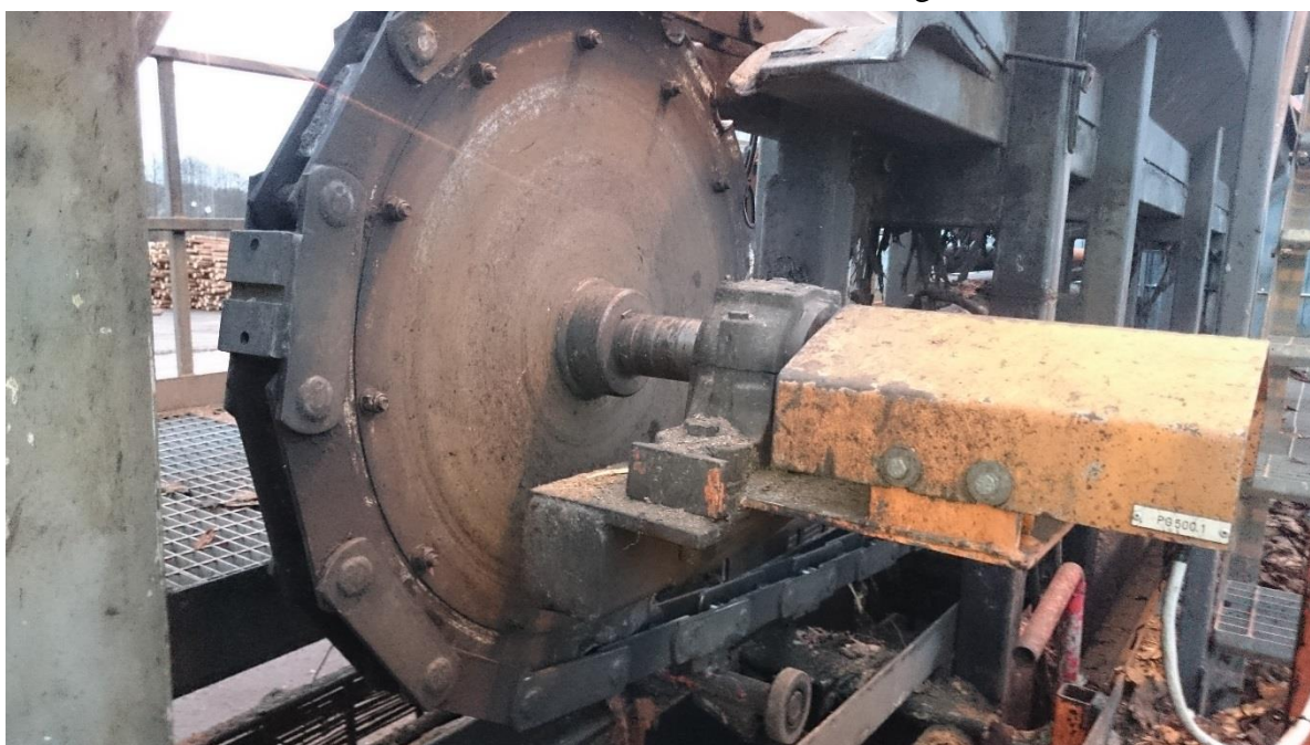
Figur 3. Vid vändhulets axel har en pulsgivare anslutits som används för längdmätning, men även bestämning av hastigheten på kerattbanan. Pulsgivaren är placerad under den gula skyddskåpan. Foto: Monika Strömgren.
