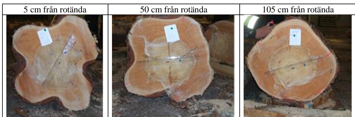
Figur 1. Måtten i tallrotstockars rot-del kan vara svåra att bestämma på grovt sågtimmer beroende på varierande barktjocklek och orundhet. Bilderna visar tvärsnitt på en stock på olika avstånd från rotändan.
