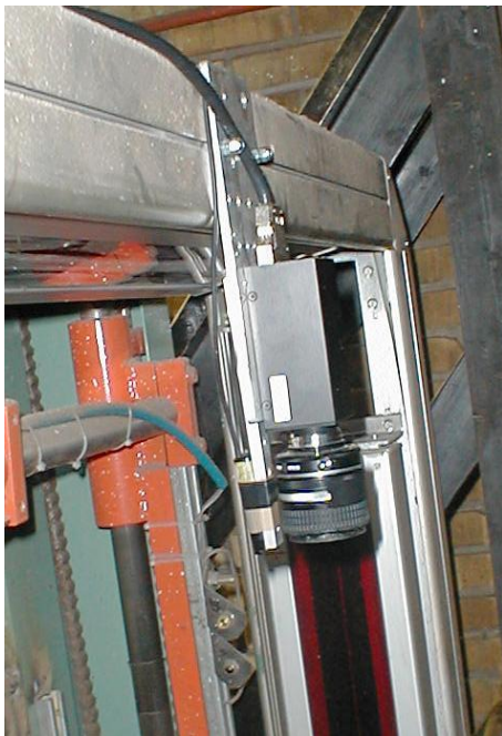
Figur 8. Fibervinkelmätare monterad i mätram (Grundberg och Nyström 2002, utkast till rapport om fibervinkelmätare).
