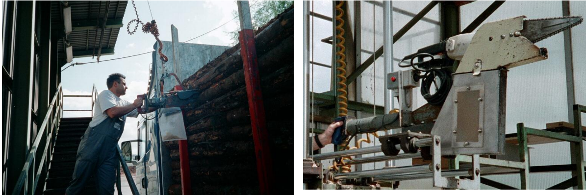
Figur 11. Kedjefräs för torrhaltsprovtagning på massavedstravar. Metoden utvecklades i Norge på 1960-talet och används idag bland annat i södra Tyskland. Vänstra fotot från StoraEnso i Karlsruhe och högra fotot från SCA i Mannheim (foton Roger Andersson, 2000).
