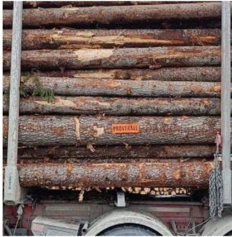
Signalskylt PROVTRAVE korrekt placerad på provtravens långsida
