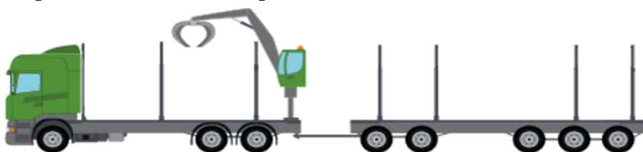
Figur 2: Ekipage bestående av en dragbil (med eller utan kran) med en eller flera bankpar (lastpositioner) och ett släp med en eller flera bankpar (lastpositioner)
