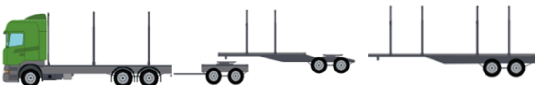
Figur 9: Timmerbil med dolly och link och trailersläp
