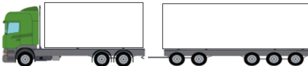
Figur 4: Ekipage bestående av en dragbil med en skäppa eller container och ett släp med en skäppa eller flera containrar
