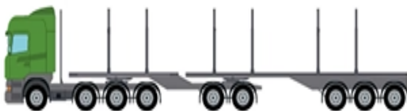
Figur 7: Trailerdragare med link och trailersläp
