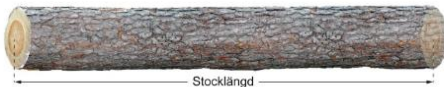
Figur 2. Med stocks längd avses det kortaste avståndet mellan stockens ändcentra.
