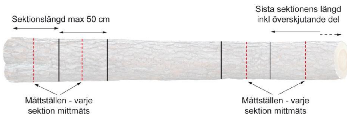
Figur 5. Måttställen för diameter vid sektionsmätning.
