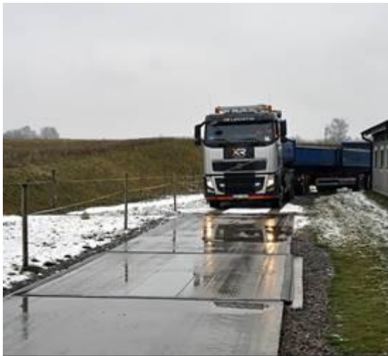
Figur 1. Viktorvåg WIM Precision till vänster, och Wånelid WTS-3-15 till höger. Att beakta vid installation är att ha plant underlag, i nivå med vågplattan, före och efter vågen. Det kan även behövas någon form av konstruktion som förhindrar att något hjul hamnar vid sidan av vågen.
