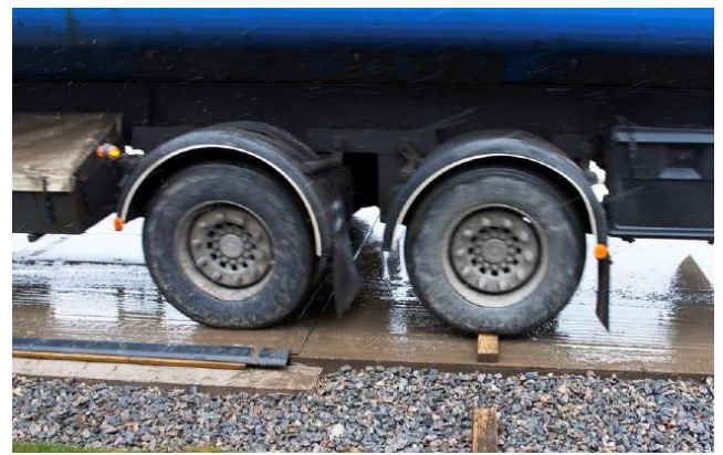
Figur 3. Störningstester med brädor. Till vänster brädor både direkt före och direkt efter vågplattan, Wånelid enkelvåg i Alingsås. Till höger bräda ca 1,4 m före vågplattan, Viktorvåg WIM Precision, Trädet, Falköping.
