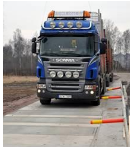
Figur 1. Viktorvåg WIM Precision till vänster, och Wånelid WTS-3-15 till höger. Att beakta vid installation är att ha plant underlag, i nivå med vågplattan, före och efter vågen. Det kan även behövas någon form av konstruktion som förhindrar att något hjul hamnar vid sidan av vågen.
