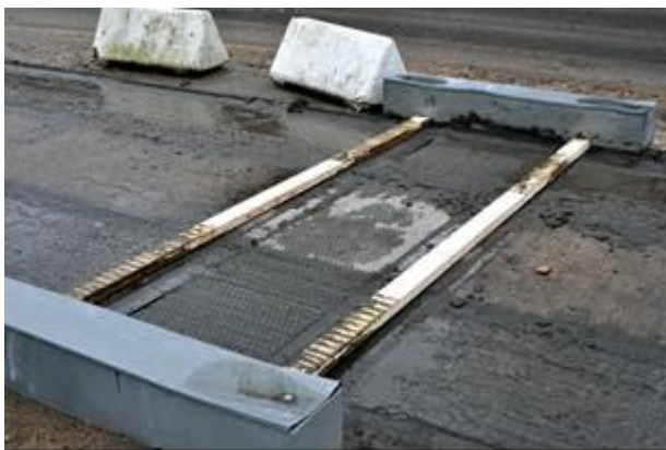
Figur 3. Störningstester med brädor. Till vänster brädor både direkt före och direkt efter vågplattan, Wånelid enkelvåg i Alingsås. Till höger bräda ca 1,4 m före vågplattan, Viktorvåg WIM Precision, Trädet, Falköping.
