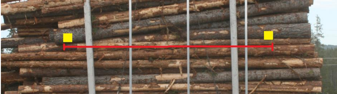
Figur 8. Exempel på markering av mätsträcka på trave (gula kvadrater).
