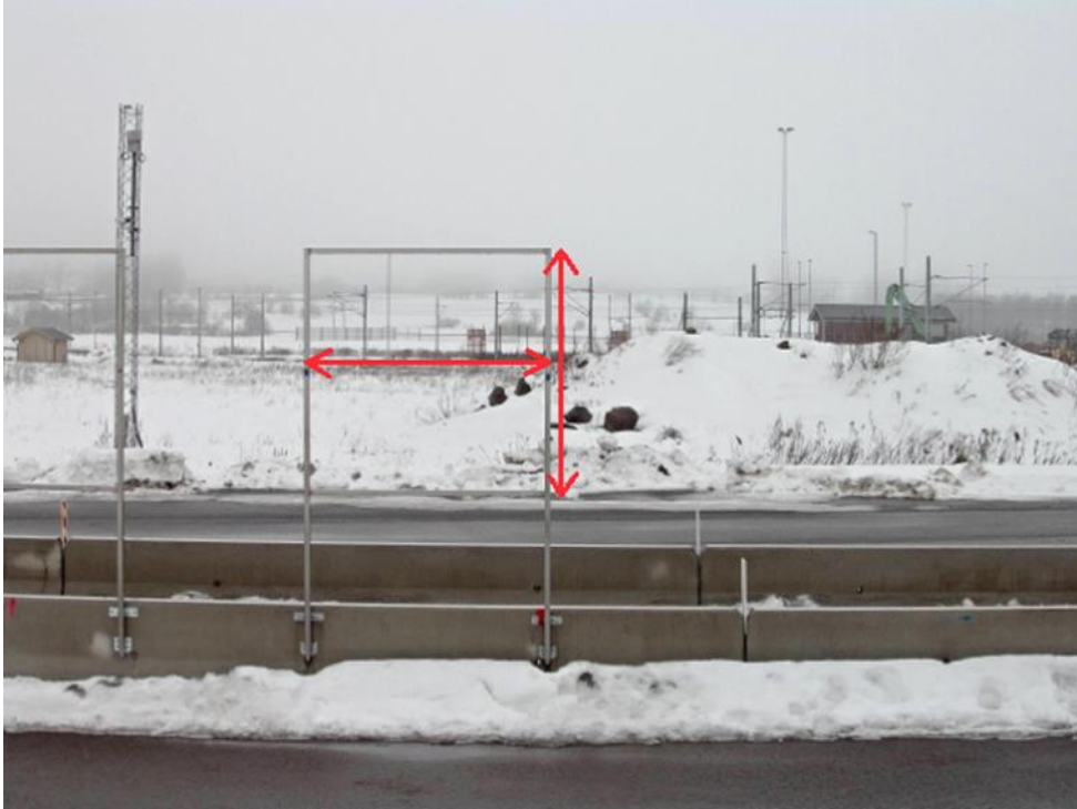
Figur 4. Exempel på montering av referensram. Bestämning av referensmått för daglig tillsyn av det vågräta måttet görs på ramens halva höjd, medan det lodräta måttet bestäms på den del av ramen som är närmast bildcentrum.
