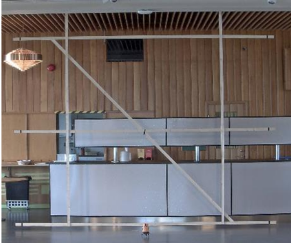
Figur 5. Exempel på kalibreringsställning med uppmärkta horisontella och vertikala avståndsmarkeringar. Ska anläggningen godkännas för olika travekombinationer, se tabell 1, krävs en kalibreringsställning för varje kombination.
