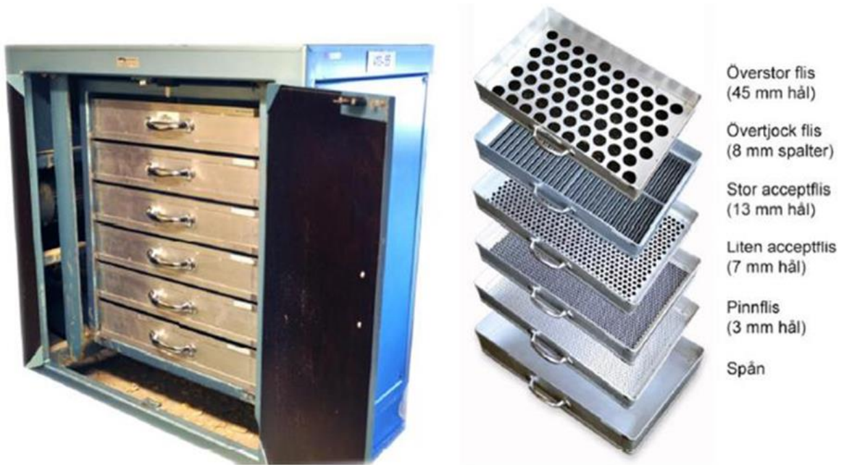
Figur 3. De sex lådorna i sållustrustningen.
