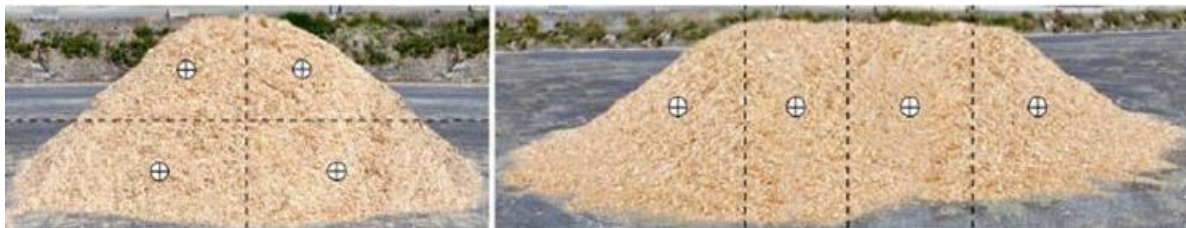
Figur 2. Princip för provtagning ur stack efter lossning när stacken har "konform" respektive "limpform". Provtagningen fördelas runt "konen" respektive växelvis på respektive sida av "limpan".
