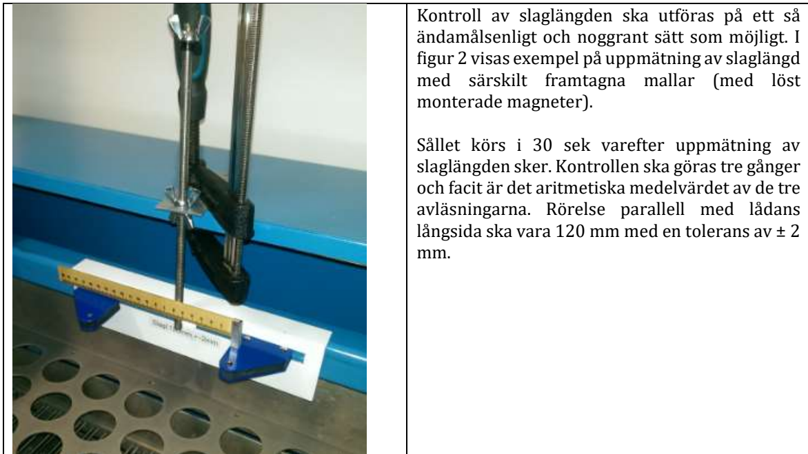
Fig. 2. Exempel på uppmätning av slaglängd.
