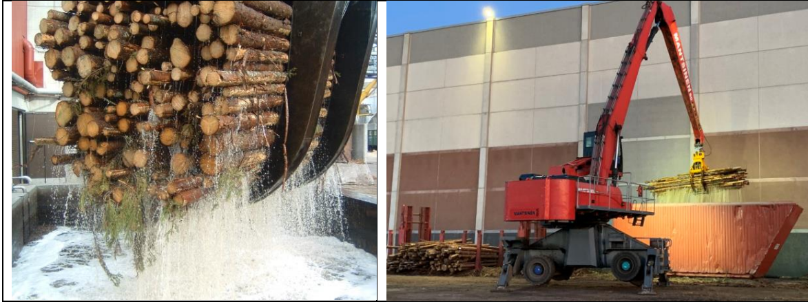
Xylometermätning med stort respektive litet badkar. Fotot till höger från Rauma.
